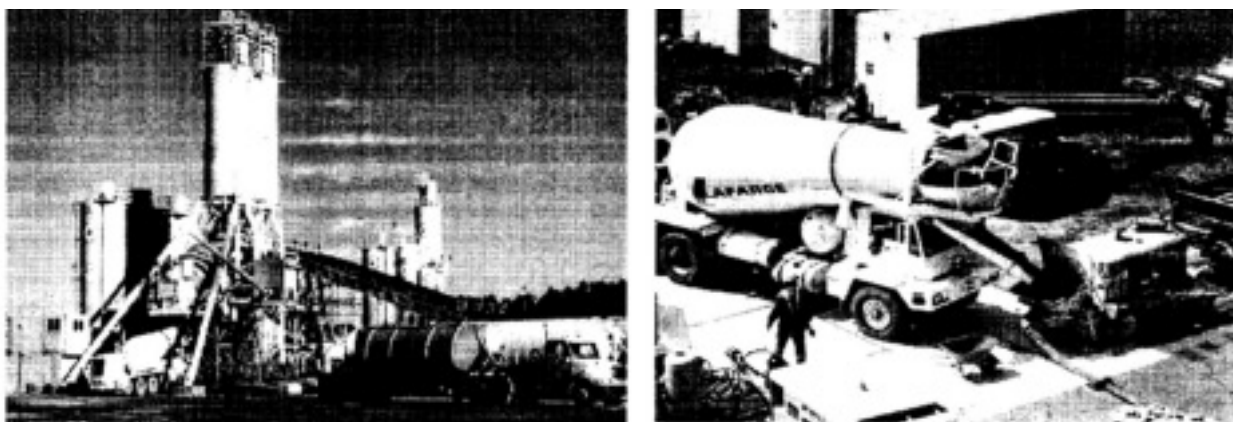
図1 コンクリートプラントと運搬ポンプ車
